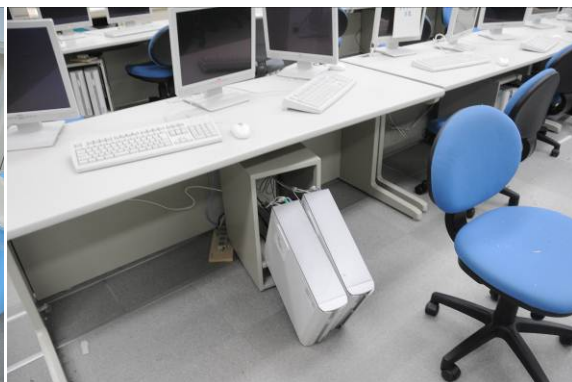
写真8 ラックから飛び出したPC本体
